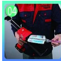
04 حفر ثقوب في الأرضيات لإصلاحها.
